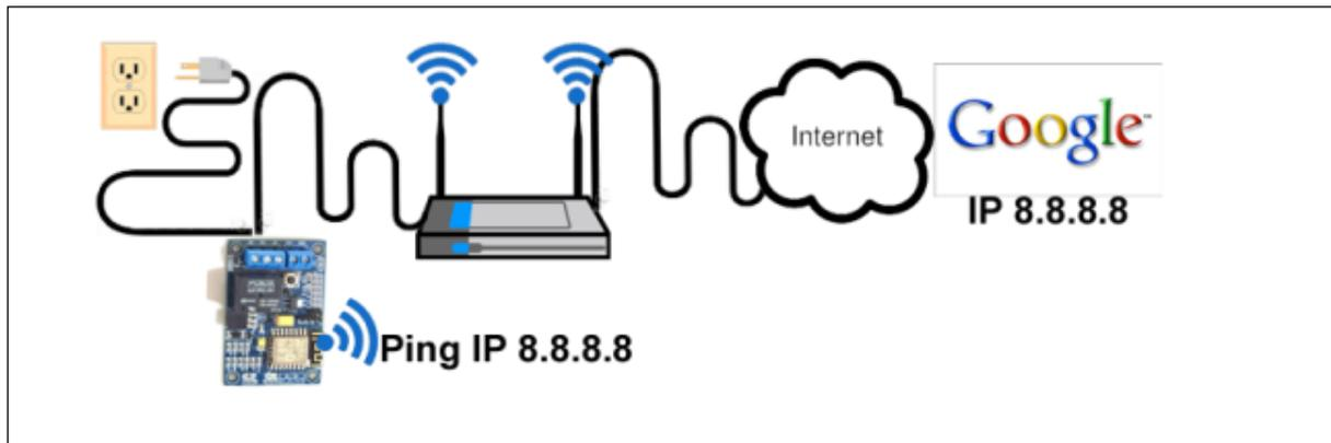
No exemplo acima o Módulo iLinq Relay foi configurado para executar o comando ping contra o IP do Google, enquanto for obtida a resposta do servidor do Google nada acontece. A partir do momento que houver uma perda de comunicação e o modulo não mais receber a resposta do comando ping, ele desligara a alimentação elétrica do roteador pelo tempo programado, forçando assim uma reinicialização do roteador e restabelecendo a conexão com a Internet ou rede caso o mesmo tenha travado.
