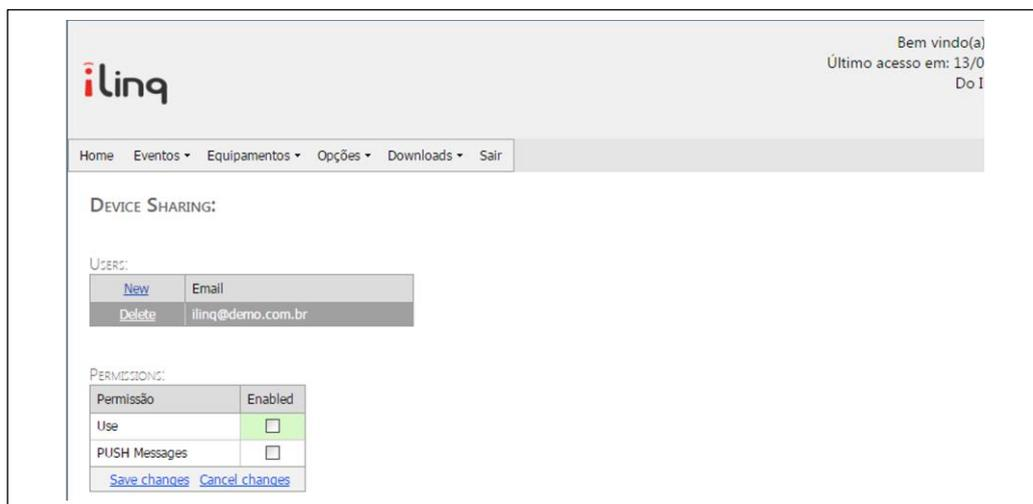
**Use** – Permite a utilização do dispositivo –Ligar. Desligar, Armar, Desarmar....
